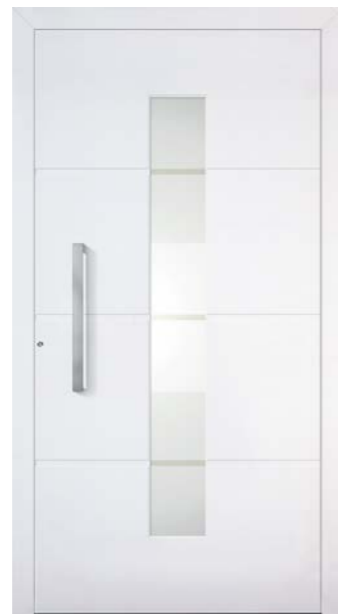
BALINO 1 Feld verglast, Oberfläche Weiß RAL 9016, Glas 3-fach ISO Sandstrahlung Balino 1 Teilflächen 1-fach/Teilflächen 2-fach Sandgestrahlt – 3 Streifen 20mm klar, Balino Griffdetail HA 328 halbrund Edelstahl matt gebürstet
